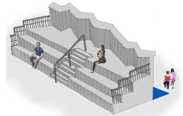
Sitztribüne mit Handlauf und Absturzsicherung und rückseitiger Boulderwand
